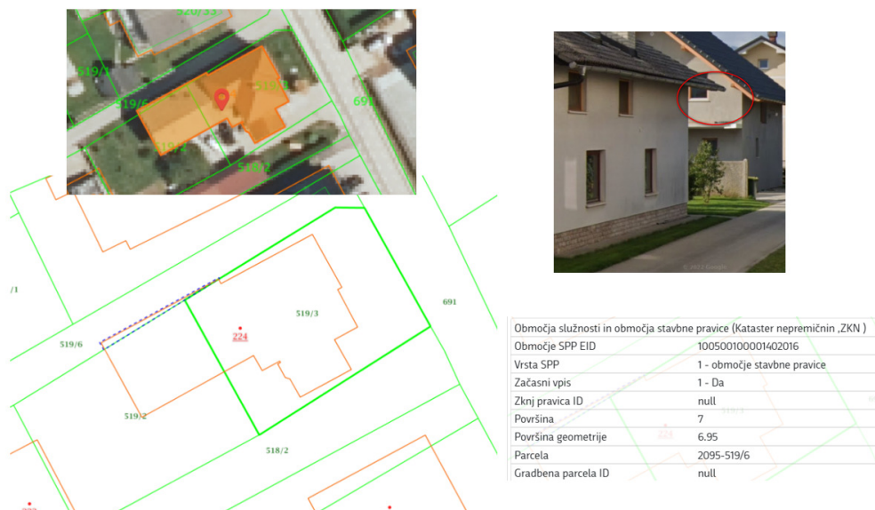
Slika 77: Določitev območja stavbne pravice zaradi posega strehe stavbe v tuj zračni prostor – vir: IS kataster.
