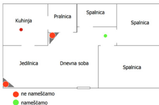
Slika 9: Mesta za nameščanje požarnih alarmov
