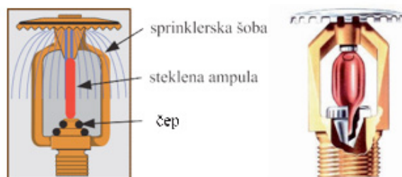
Slika 101: Shema sprinklerske šobe
