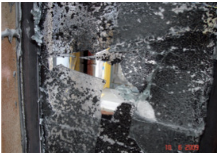
Slika 44: Steklo, ki omogoča prenos požara
