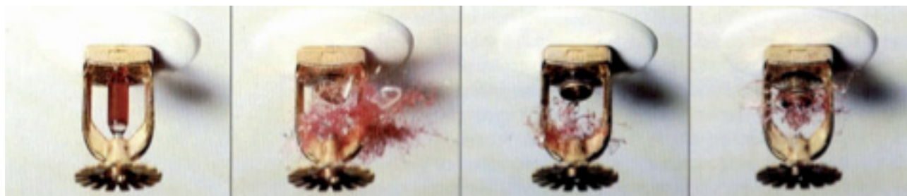
Slika 102: Sprinklerji in prikaz proženja
