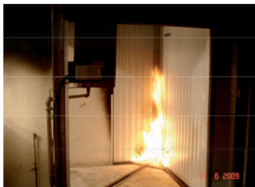
Slika 39: Požarni preskus fasadnega panela po metodi SBI
