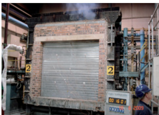
Slika 36: Dokaz požarne odpornosti dviznih vrat
