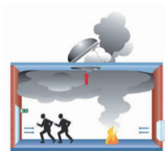
Slika 81: Shematski prikaz naravnega odvoda dima
