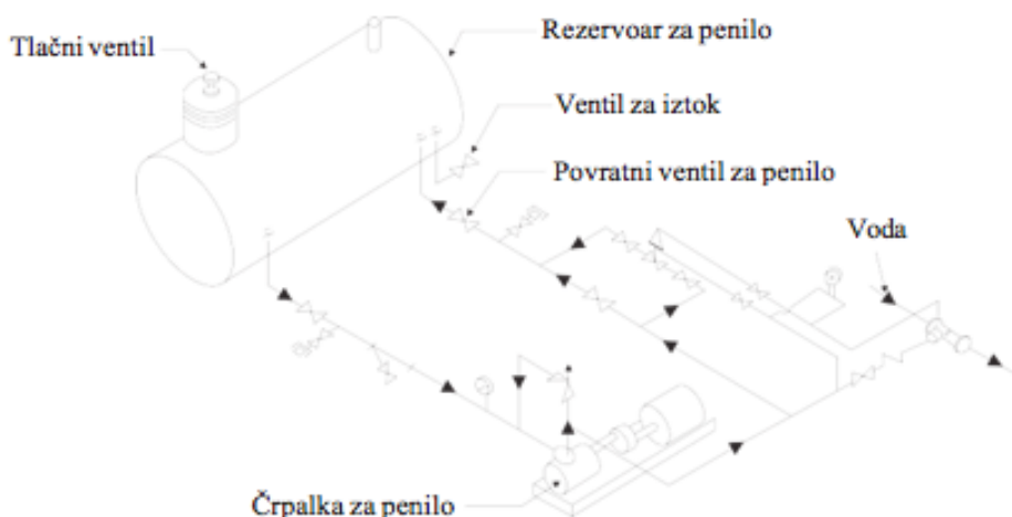
Slika 104: Sistem za gašenje s peno
