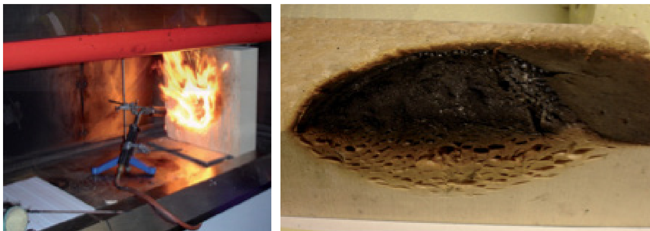
Slika 40: Reakcija polnila fasadnih oz. strešnih plošč iz poli-izo-cianurata na plamen in visoko temperaturo
