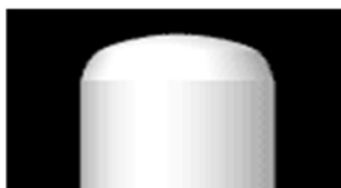
Slika 23: PC-poliranje optičnega vlakna
