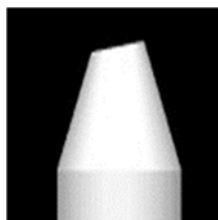
Slika 24: APC-poliranje optičnega vlakna
