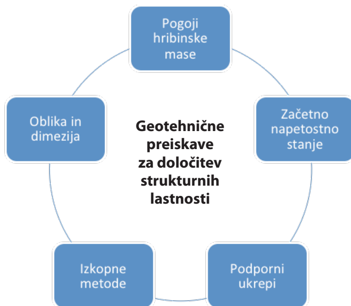
Slika 4: Dejavniki, ki vplivajo na strukturne lastnosti pri podzemnih gradnjah
